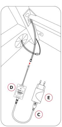
Verbinden Sie die beiden Stromkabel.
