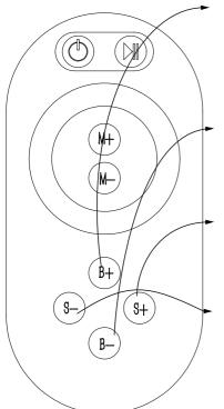
**B+**: Die Helligkeitssteuerung, jedes Mal wenn sie diese Taste drücken, erhöhen Sie die Helligkeit um eine Stufe, insgesamt gibt es 25 Stufen.
